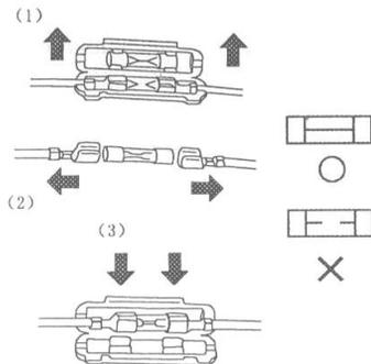
Блок предохранителей установлен под крышкой в правой части рамы. Если есть какие-либо неполадки в электрической системе, предохранитель должен быть проверен.
