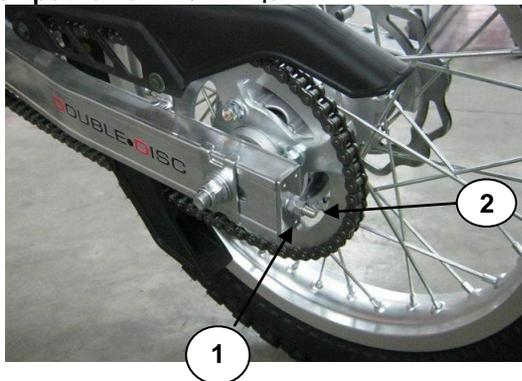
(1) Контрящая гайка, (2) Винт
