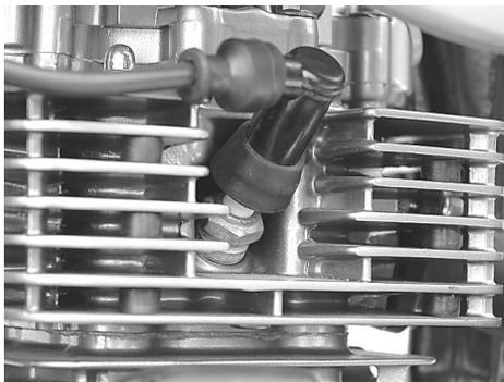
1. Отсоедините наконечник от свечи и выкрутите свечу из головки цилиндра.
