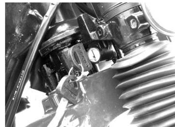
Для того чтобы заблокировать руль, поверните руль налево, затем вставьте ключ с нажатием вниз и поверните его по часовой стрелке, до полной блокировке руля.
