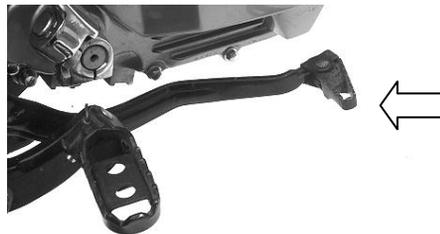
При нажатии на эту педаль работает задний тормоз и лампа тормоза на заднем фонаре (стоп сигнал) будет автоматически зажжена.
