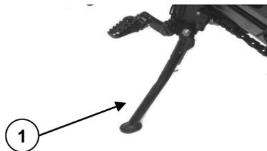
Этот мотоцикл оборудован боковой стойкой. Чтобы установить мотоцикл на боковой стойке, наступите ногой на рычаг боковой стойки, удерживая левой рукой руль, и тяните вниз боковую стойку до фиксирования, так чтобы мотоцикл был установлен на стойке.
