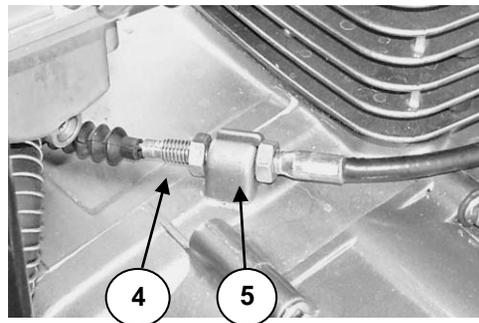
Перед тем как пользоваться сцеплением, проверьте значение зазора рычага сцепления, которое должно быть 4 мм. Если зазор не соответствует требуемому значению, проведите регулировку в следующей последовательности: Сделайте регулировку хода рычага сцепления на двигателе (4), (5).
