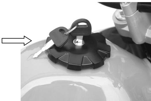
Для того чтобы открыть крышку бака, вставьте ключ зажигания и поверните его по часовой стрелке. Затем крышка вынимается вместе с ключом. Чтобы закрыть крышку, выровняйте ключ по стрелке и подтолкните его вниз, пока не услышите щелчок. Это означает, что бак закрыт. Выньте ключ.
