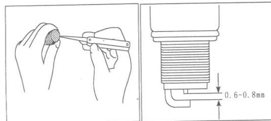
1- зазор 0,6-0,8 мм
