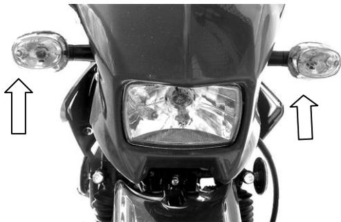
1. Удалите стекло лампы, выкручивая два винта.
