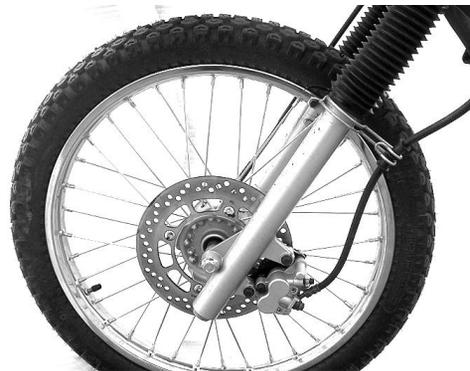
Проверьте передние тормозные колодки, чтобы видеть, не изношены ли он до предельной метки. Если изношены выше метки, замените колодки.
