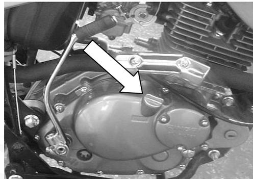
Меняйте масло двигателя и трансмиссии после первых 1000 км и каждые 5000 км после этого. Меняйте масло, когда двигатель находится в тёплом состоянии, чтобы старое масло вытекло полностью, следующим образом:
