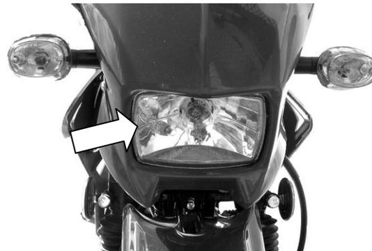
1. Выкрутите винт крепления фары и снимите фару.
