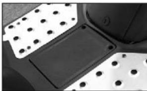
Мотороллер оборудован свинцово-гелевым аккумулятором. Аккумулятор находится в нижней части под ковриком для ног. Откидная крышка прикручена винтами.
