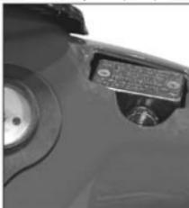
! Необходимо следить за тем, чтобы едкая тормозная жидкость при наполнении емкости не выступала из вентиляционного отверстия крышки и тем самым не повреждала лак или даже Вашу кожу.
