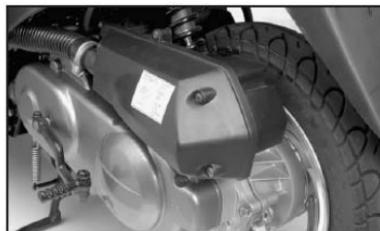
Проверяйте и меняйте воздушный фильтр регулярно каждые 2500 км или самое позднее каждые 5000 км. Для этого удалите закрепляющие винты и выньте крышку фильтра. Теперь бумажный элемент может быть заменен:
